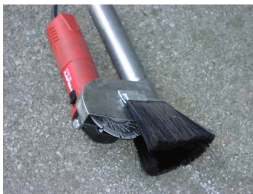
Vinkelslip från Hilti (DC 125-S/EX) med kapskiva för sågning i betong, försedd med ny utsugskåpa från SP.
