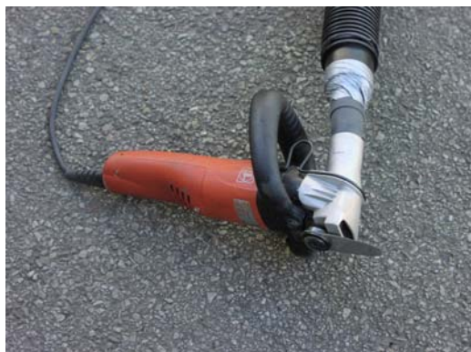
Ny oscillerande kniv från Fein, modell FSC 1.6, som användes för skärning av PCB-haltig fogmassa.
