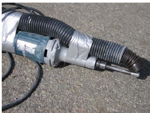
Slipverktyg för slipning i svåråtkomliga utrymmen. Till rakslipen från Bosch (GGS 27LC) är ett utsug med en ställbar slang monterad. Bild till höger: Slipning med raksplip pågår.
